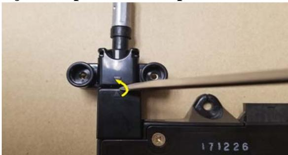
Utilice un destornillador plano para abrir la cubierta.
